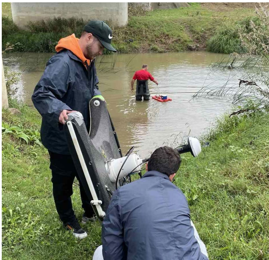
Közös vízhozammérés a Túr folyó túrterebesi szelvényében
