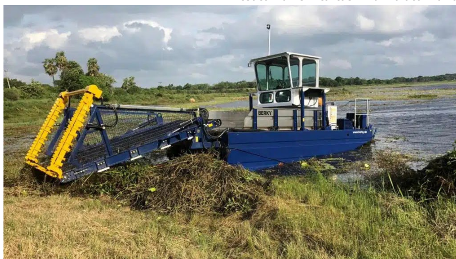
Vízinövényzetet eltávolító-szállító úszómunkagép (Berky Triton 550 – 1500)
