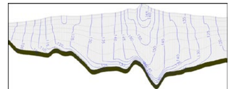
4. ábra: A modell nyugat-keleti metszete az ekvipotenciális vonalakkal [m]
