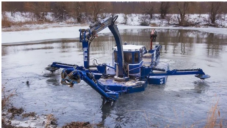
Többfunkciós szárazföldi és kételtű kotróhajó (Berky Poseidon 770)
