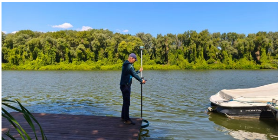
Úszóművek GPS-szel történő bemérése
