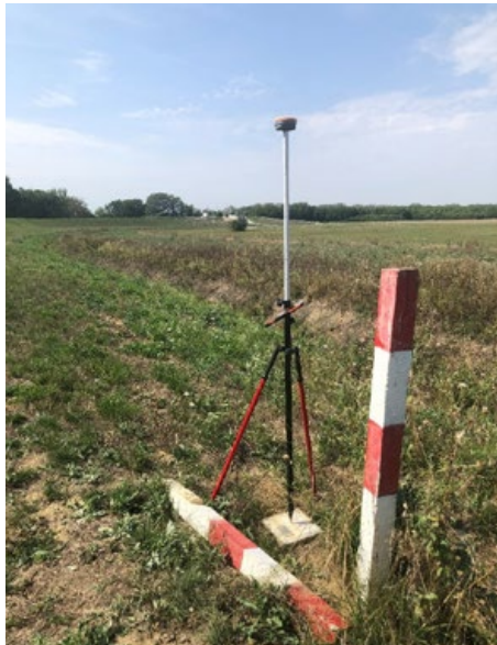
Bázis állomás az ismert ponton felállítva, háttérben a leeresztő műtárgy
