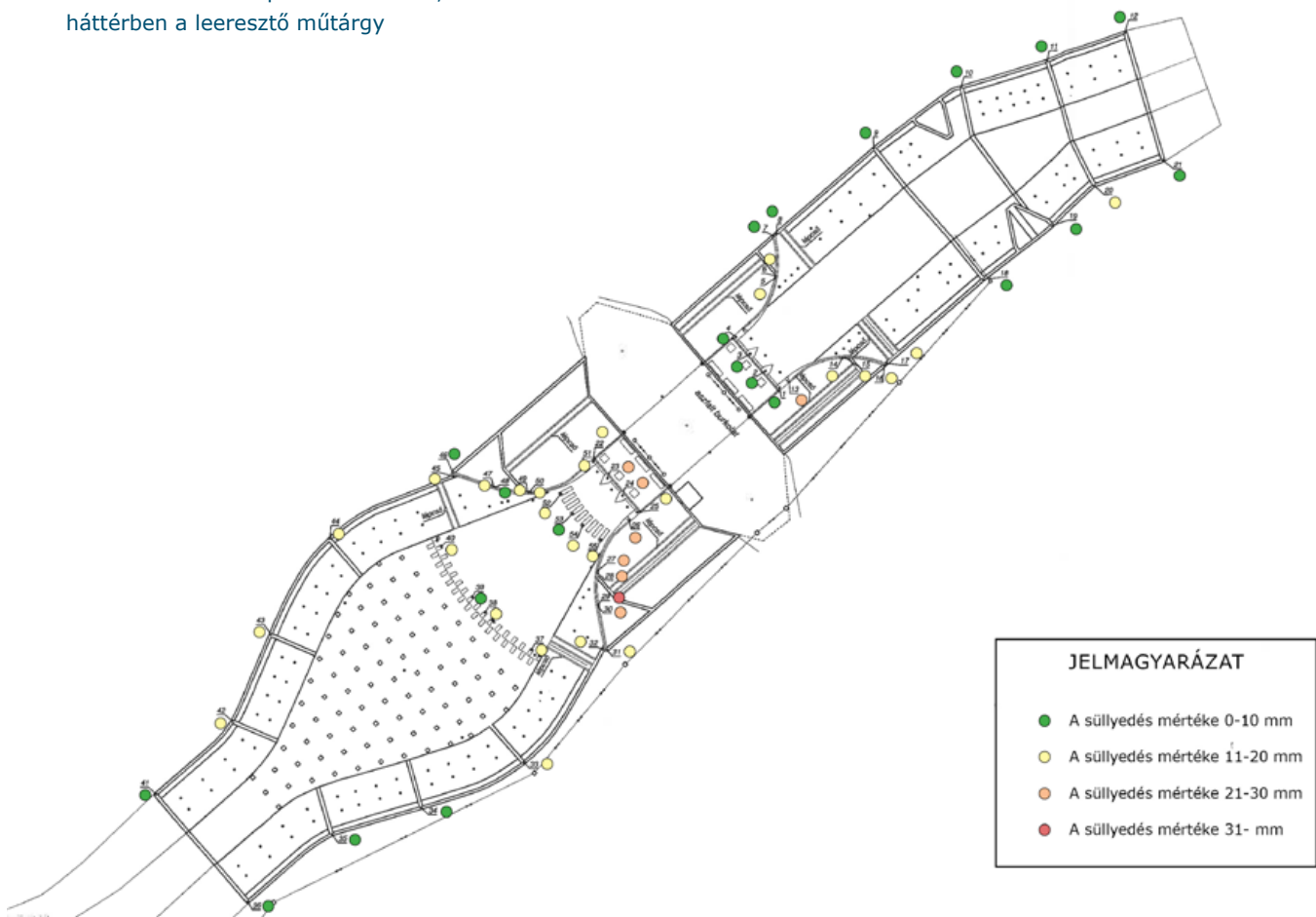
Süllyedés ábrázolása a 2025-ös mérési eredmények alapján
