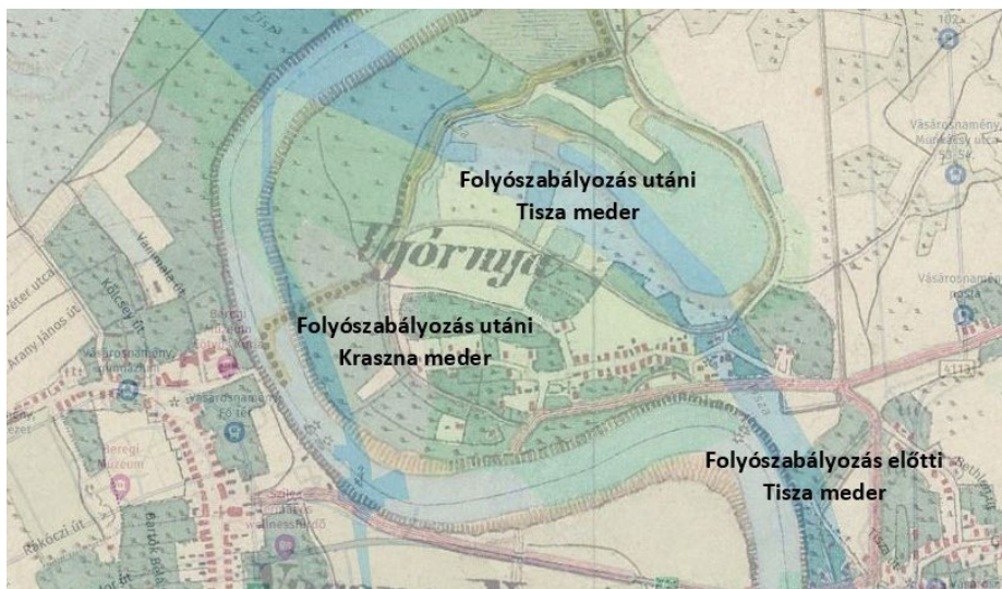
3. ábra A Kraszna torkolati szakasza és a Tisza medrének változása összehasonlítva a XIX. század elején a jennel
