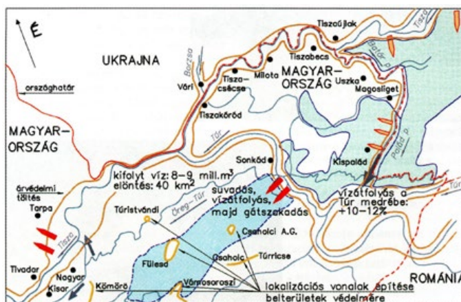
26. ábra. Vízátfolyás Ukrajnából a Palád-patakon keresztül és a Túr bp. 12+000 és 12+400 tkm szelvényében suvadásból kifejlődő szakadások
