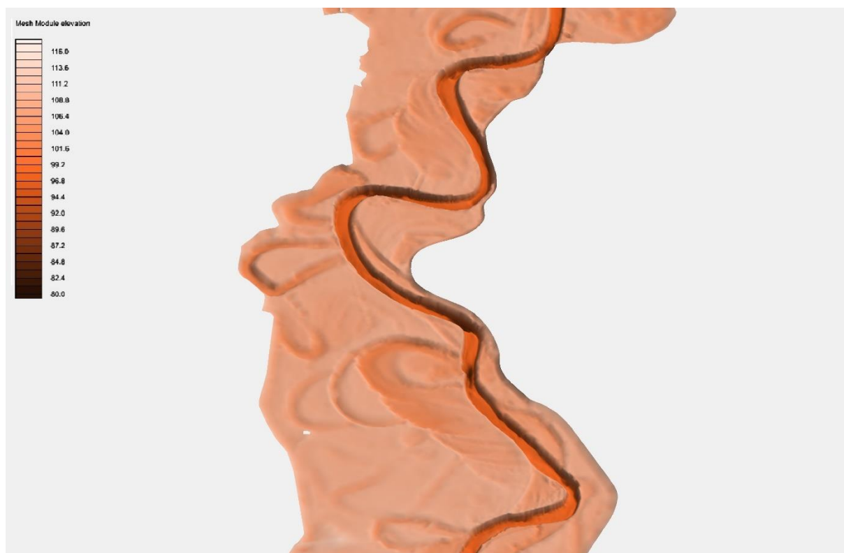
2-8. ábra: Perspektivikus árnyékolt kép a Tiszavid és Aranyosapáti környéki számítási rácshálójáról a terepmodell feltüntetésével
