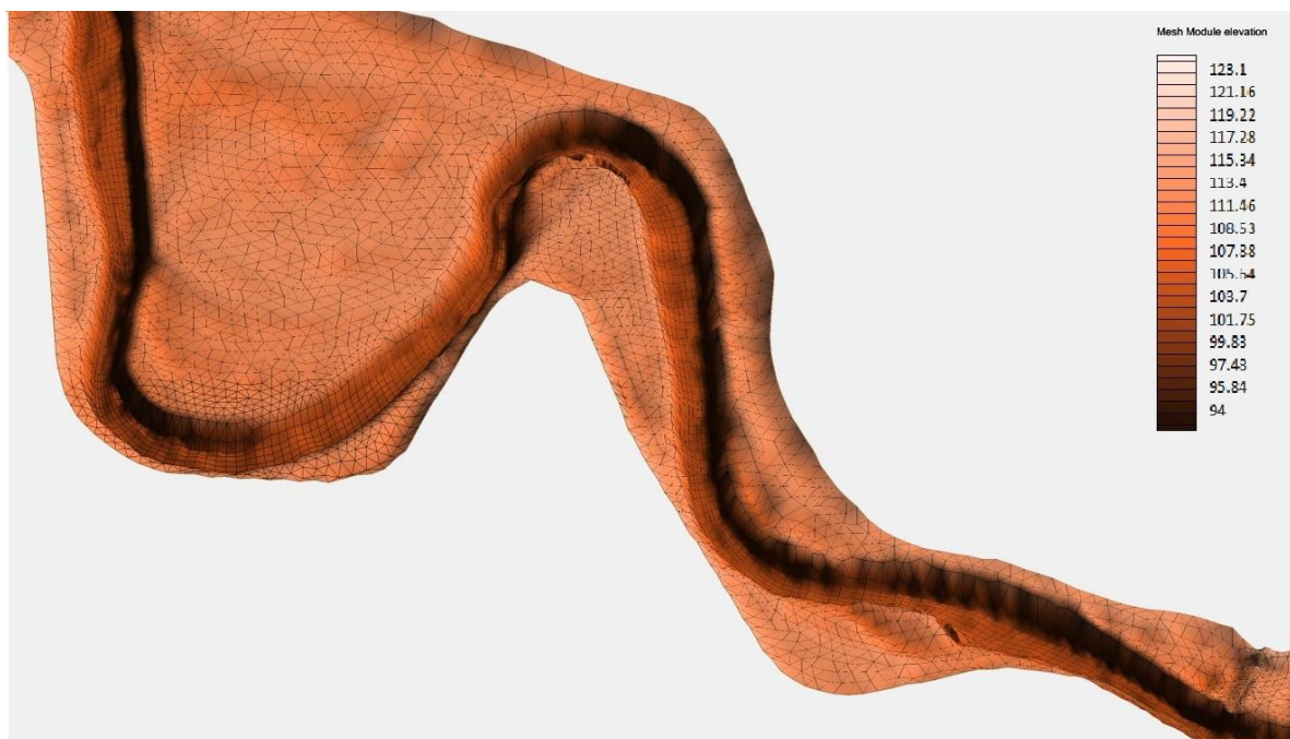
2-9. ábra: Perspektivikus árnyékolt kép a Szatmárcseke és Tivadar környéki számítási rácshálójáról a terepmodell és a rácsháló feltüntetésével
